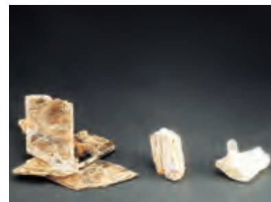
Algunos de los minerales más comunes son: la mica, el feldespato y el cuarzo, los que forman parte de la familia de los silicatos
