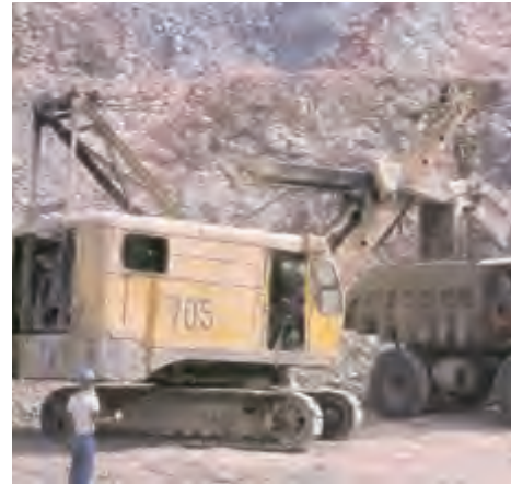
Maquinaria pesada utilizada para la extracción de los minerales. La fotografía nos muestra la extracción de la caliza ( \text{CaCO}_3 ).
